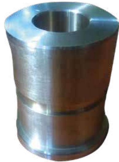
Fabricación de bujes en bronce, NYLAMID, A-36, hierro colado, etc.
